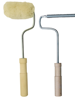
ウールローラー 脱泡ローラー
