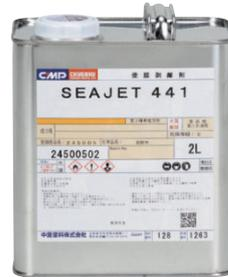
人体や環境に安全で刺激臭の少ない中性タイプです。塗膜をスムーズに剥離するためできるだけ厚く塗布します。500ミクロン程度の厚みを剥離させるためには、1m<sup>2</sup>あたり約0.4Lのシージェット441が必要です。(2L缶で約5m<sup>2</sup>)
