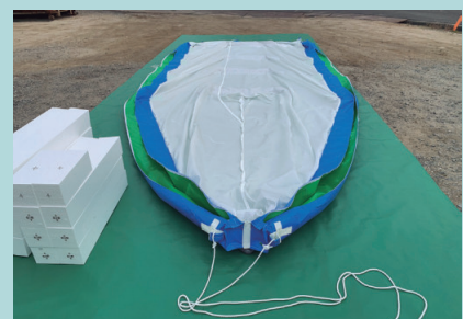
フロート内部に芯材を入れていきます
