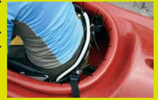
背中のベルトは腰が軽く触れる程度。寄りかかったり、上体を起こすために締めあげたりしないこと。後方への動きが制限されて腰痛の原因となる。ベルトは、尻が後ろにずれないためのものと考えよう
